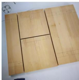
图 1-2 测量、选择连接的木材尺寸
