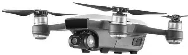
图 1-4 搭载 FlightAutonomy 系统的大疆无人机
